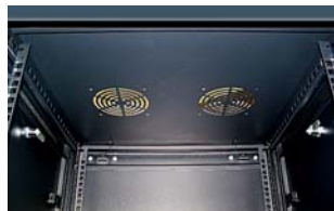
Deckel mit Ausnehmungen für Lüfter Rückwand mit 4 Befestigungslöchern oben
